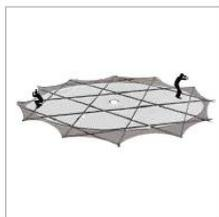
**Carborado (4):** (développement en cours) Dispositif semi-fixe d'observation et de prélèvement flottant sur la canopée.
